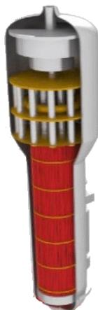
**Figura 18. Generador de vapor**
