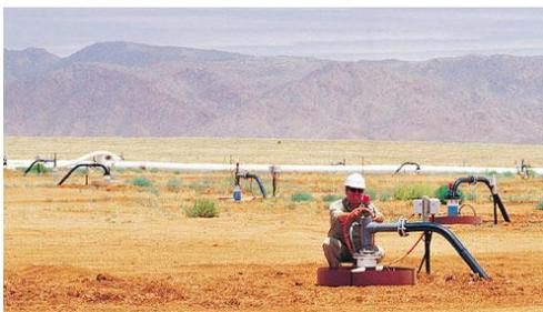
**Figura 25. Una mina utilizando el método de ISL**
